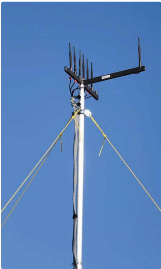
Le réseau d'antennes – les six antennes à l'arrière – pour la formation de faisceaux, l'antenne à l'avant servant à la détection. (Source: Haute école spécialisée bernoise)
