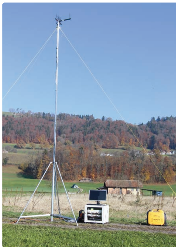
Le projet de drones de la Haute école spécialisée bernoise testé sur le terrain. On voit l'un des deux nœuds de capteur avec générateur de courant, le Rack IT ainsi que le mât d'antenne avec le réseau d'antennes. (Source: Haute école spécialisée bernoise)
